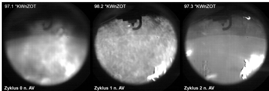
Abbildung 6.29: Aufnahmen des Rußeigenleuchtens im Katalysatorheizbetrieb während der Expansion einer antagonistischen Verbrennung (li.), des ersten Zyklus nach der antagonistischen Verbrennung (m.) sowie des zweiten Zyklus (re.). [133]
