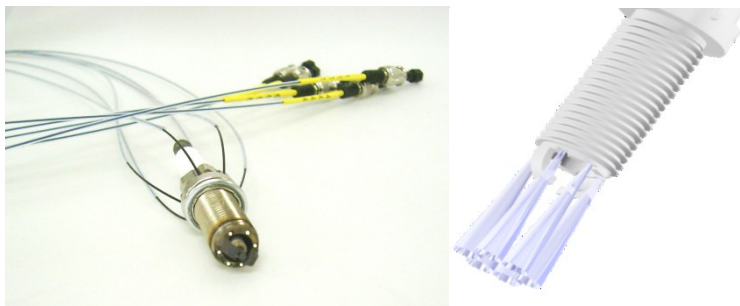
Abbildung 3.2: Lichtleiterzündkerze mit sechs Kanälen, rechts sind die Beobachtungsvolumina der Sonden angedeutet.
