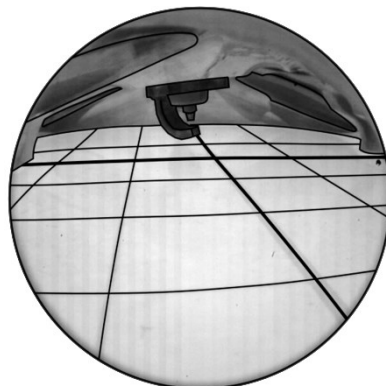
Abbildung 5.4: Sichtbereich der optischen Aufnahmen. Das Gitter auf Höhe des Zylinderdecks besitzt eine Netzgröße von 10 \times 10 \text{ mm}^2 . [133]
