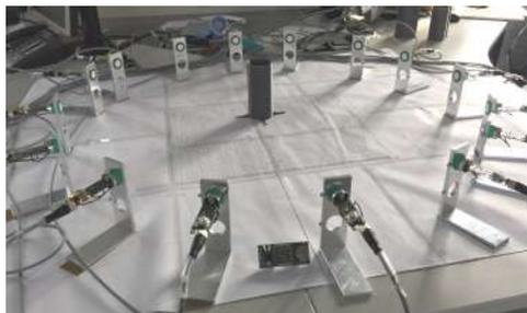
Abbildung 3.6: Aufbau des bildgebenden Luftultraschallsystems
