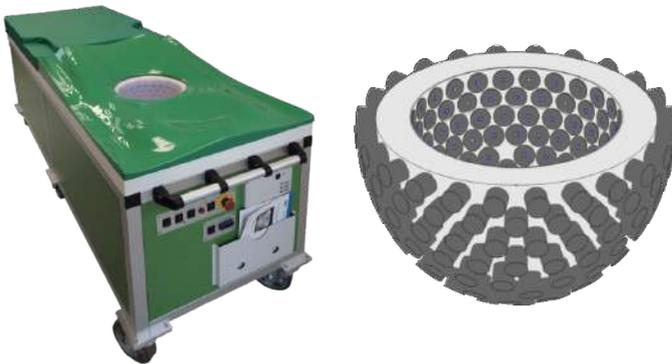
Abbildung 2.7: 3D-USCT-II-Gerät (links) am IPE mit halbellipsoider Apertur (rechts)
