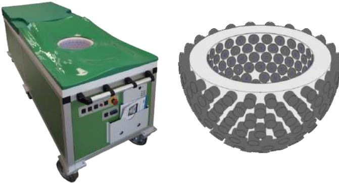
Abbildung 1.2: 3D-USCT-II-Gerät (links) am IPE mit halb-ellipsoider Apertur (rechts)
