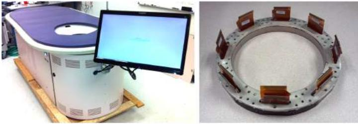
Abbildung 2.6: In der linken Abbildung ist das SoftVue-System von Delphinus dargestellt. Das Ring-Array mit 2048 Ultraschallwandlern zeigt die rechte Abbildung. Bilder entnommen aus [15].
