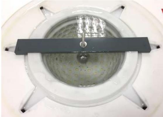
Abbildung 6.12: Der Messaufbau mit der Stahlkugel als das Kalibrierungsobjekt.
