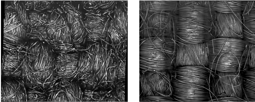
Abbildung 2.2: CLSM-Aufnahmen von Gärtuchoberflächen: links ein Baumwolltuch, rechts ein Polyestertuch; Bildbreite je 2,3 mm
