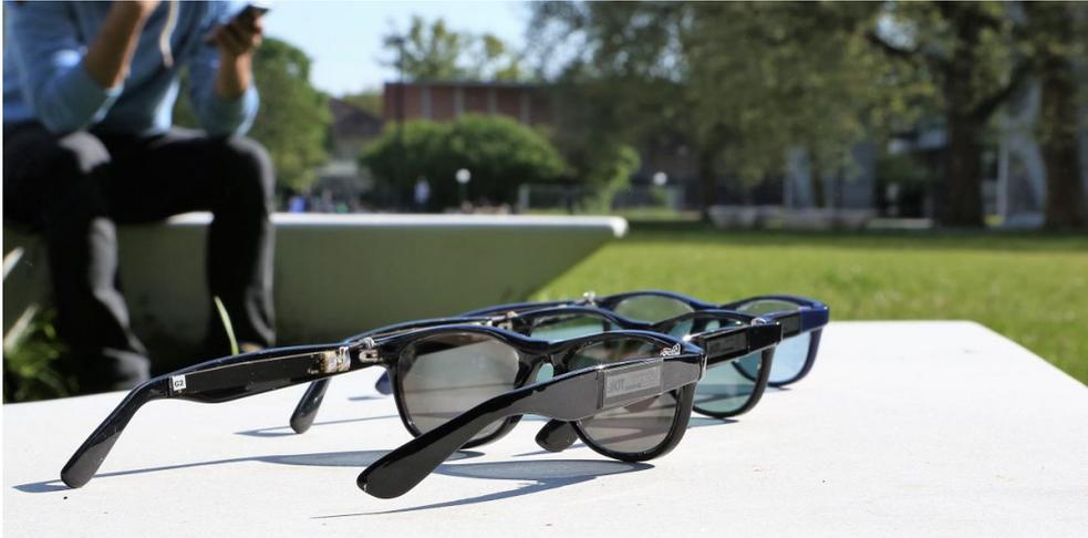
Abbildung 1.3: Die im Rahmen dieser Arbeit mitgestaltete Prototyp-Studie intelligenter Sonnenbrillen (*Solarbrille* oder *Solar Glasses*). Die in die Brillengläser integrierten organischen Solarzellen liefern auch bei Raumbelichtung genügend Energie, um eine elektrische Schaltung und zwei Displays zu betreiben.
