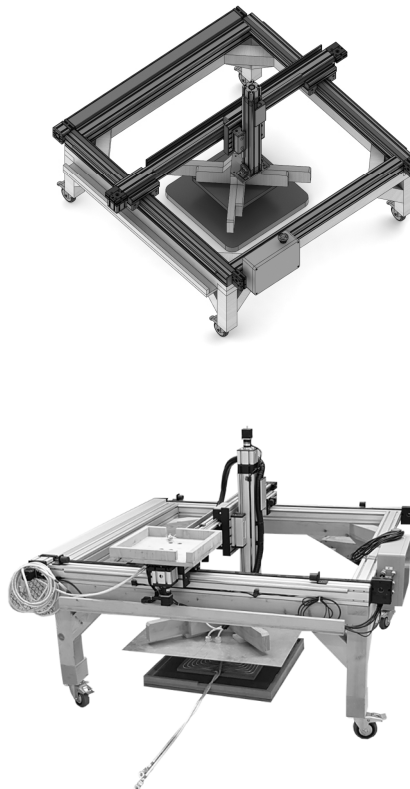
Abbildung 6.20: Finaler Aufbau der Positioniereinheit inkl. montiertem Sekundärspulensystem.
