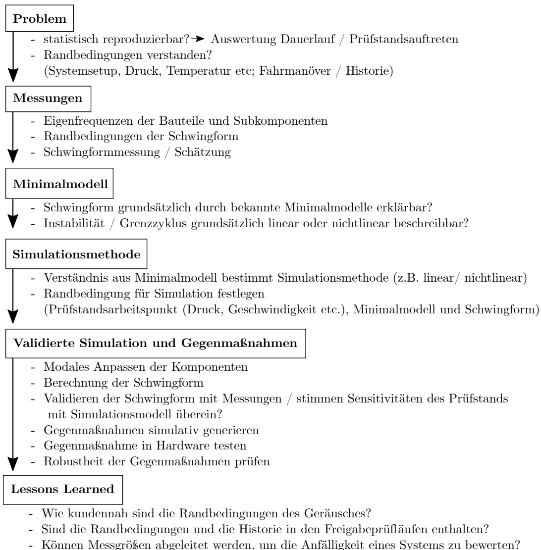
Abbildung 6.1: Methodische Vorgehensweise beim Auftreten eines Quietschgeräusches und zur Erstellung robuster Gegenmaßnahmen im Entwicklungsprozess
