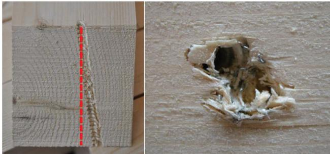
Bild 6-13 Schnitt durch einen Schraubenkanal links (Versuch 6-5) und Kreuzungspunkt der Schrauben bei einer Variante gekreuzt rechts (Versuch 7-5)
