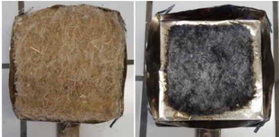
Abb. 5 Probe vor (li.) und nach eigenständigem Schwelen
