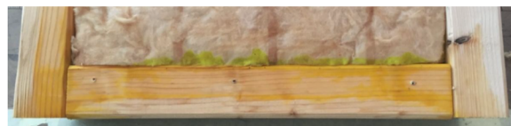
Abb.18 Nasse Fußrippe bei mineralischer Faserdämmung (Quelle: Fraunhofer WKI / Lucas van der Meer)
