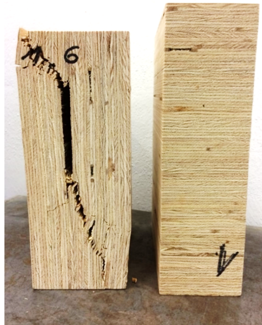
Abb. 3 Versagen von parallel (||) belastetem FSH auf Grund ausknickender Furnierlagen (links). Belastungsrichtung rechtwinklig (⊥) zu den Furnierlagen (rechts).
