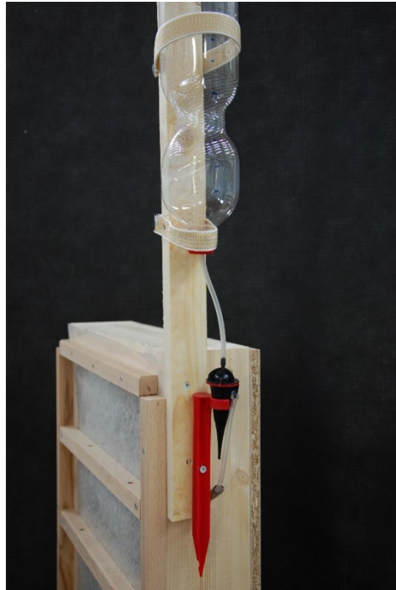
Abb.17 Versuchsaufbau zur Bestimmung des Einflusses von punktförmig injiziertem Wasser in einer Holztafelkonstruktion (Quelle: Fraunhofer WKI / Lucas van der Meer)
