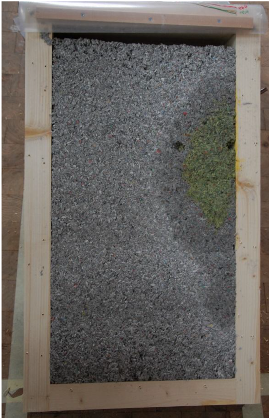
Abb.19 Dreidimensionale Verteilung injizierten Wassers bei einer Cellulosedämmung (Quelle: Fraunhofer WKI / Lucas van der Meer)
