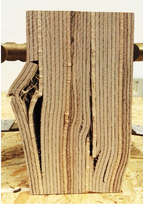
Abb. 4 Ausknicken der Furnierlagen bei Buchen-FSH Typ Q unter Belastung parallel zur Furnierorientierung
