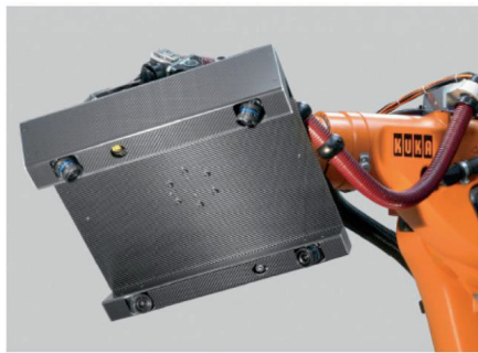
Abbildung 3-10: Robotergeführtes Messsystem (Falkenrich 2012)
