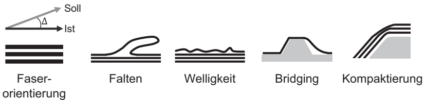
Abbildung 2-5: Defekte im Preform
