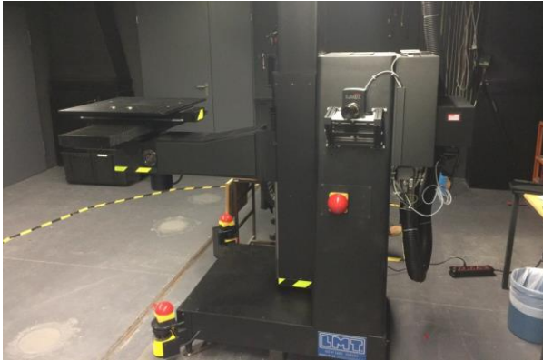
Abbildung 5.1: Verwendete Goniometer mit Farbmesskamera inklusive einstellbare Befestigung
