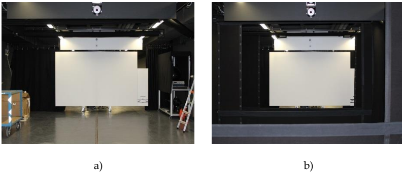
Abbildung 5.4: Messraum mit Schirm aus der Lichtquelleperspektive: a) ohne und b) mit Blendensystem
