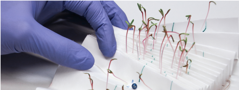
Abbildung 1: Visuelle Klassifikation von Zuckerrübenkeimlingen nach ISTA-Test.
