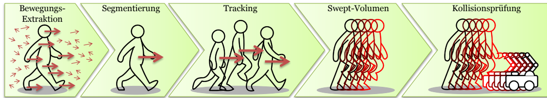
Abb. 4.14.: Schritte der Bewegungssegmentierung und Prädiktion 4 .
