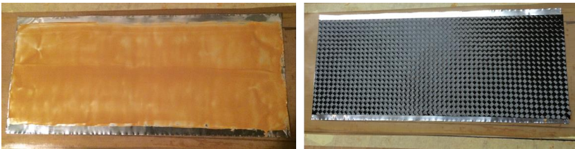
Abb. 44: links: Metallfolie als Probenträger mit Klebstoffauftrag; rechts: Auf eine Metallfolie als Träger auflaminierte Probe
