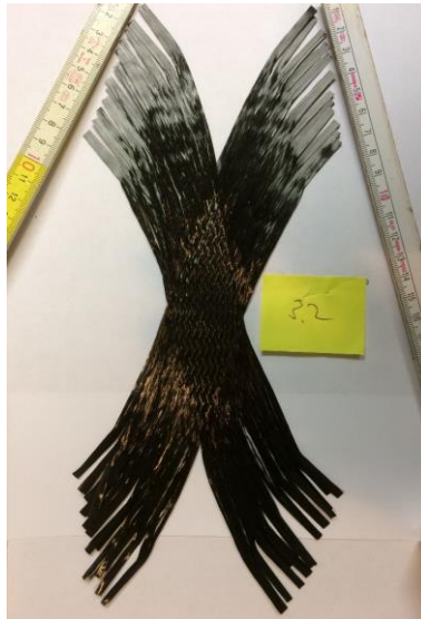
Abb. 33: Probe der Messung PFT3-2 nach der Prüfung. Der sichtbare Versatz zwischen der Zugseite und der Druckseite entsteht durch paralleles Abgleiten der Faserbündel
