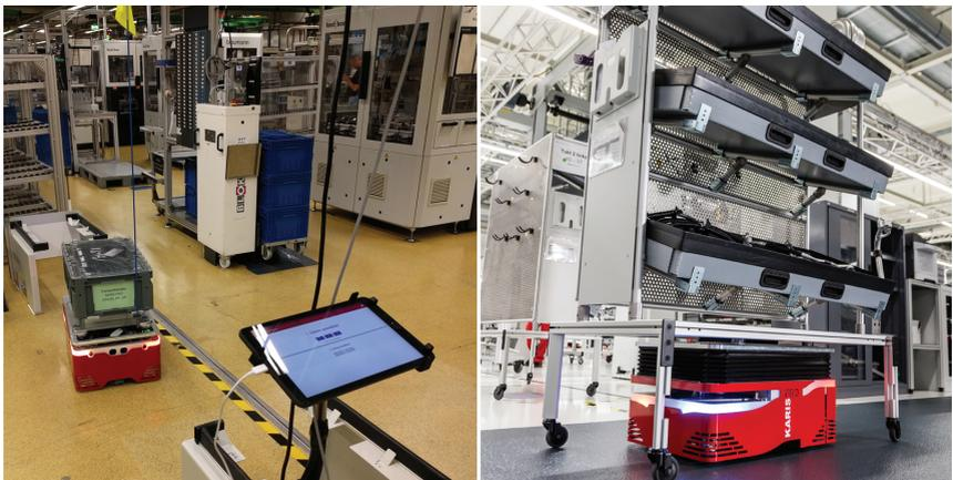
Abbildung 5.7: Modularität auf Systemebene durch baugleiche Fahrzeuge für verschiedene Anwendungen, hier beim Transport von Kleinladungsträgern (links) und Warenkörben (rechts)
