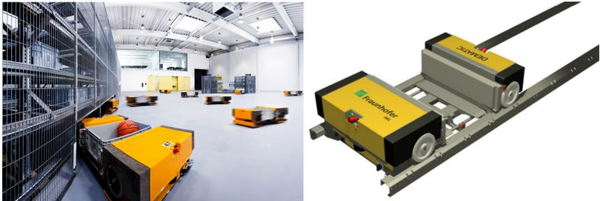
Abbildung 2.8: Zellulares Transportsystem frei navigierend im FTS-Betrieb (links) und im Shuttlebetrieb auf Regalschienen (rechts)
