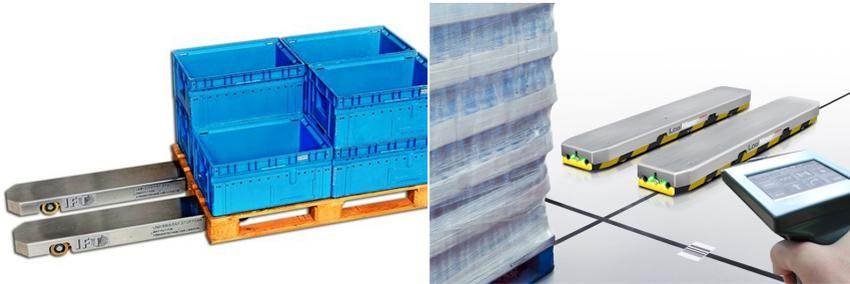
Abbildung 2.3: Das Doppelkufensystem (links) und der von Eisenmann industrialisierte LogiMover (rechts)
