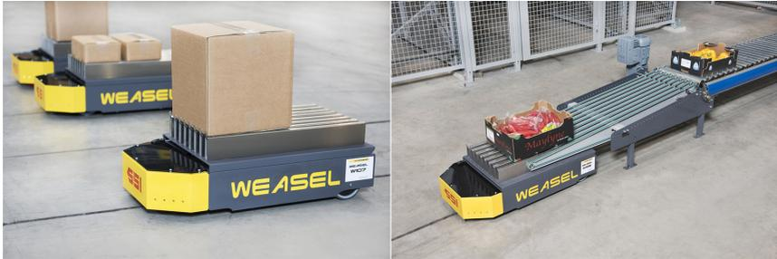
Abbildung 2.2: Weasel von SSI Schäfer (links) bei der Aufnahme eines Ladungsträgers während der Fahrt (rechts)
