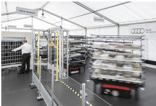
Abbildung 5.13: Schutzzäune und Lichtgitter trennen den Arbeitsbereich zwischen Mensch und FTS (Bild: Audi AG)
