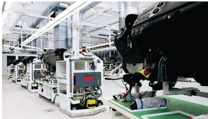
Abbildung 5.6: Nach integralen Ansätzen für die kundenindividuelle Anwendung hergestelltes Transportsystem (Bild: SEW eurodrive)
