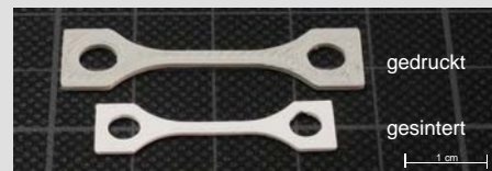
Gedruckte und gesinterte Zugprobe 40 vol% Al 2 O 3 in ABS
