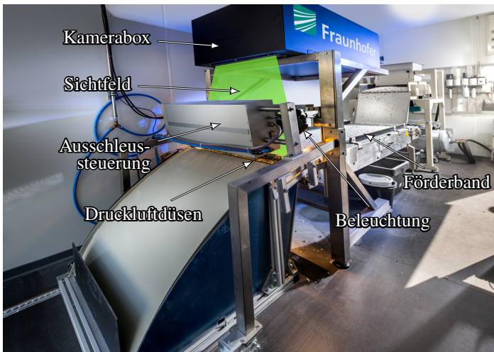
Abbildung 1.2: Beispiel eines Schüttgutsortiersystems am Fraunhofer-IOSB.
