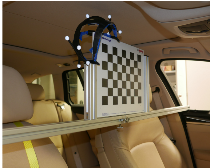
Abbildung 3.14.: Versuchsaufbau zur Bestimmung der Streuung der Transformation des Kamerakoordinatensystems k in das Koordinatensystem des Motion-Capture-Targets t über das Weltkoordinatensystem w , \mathbf{T}^{k \rightarrow t} = \mathbf{T}^{k \rightarrow w} \cdot \mathbf{T}_i^{w \rightarrow t} . Das Schachbrett und das Motion Capture-System sind während der Messwiederholungen fixiert. Bei jeder Messung wird die Kalibrierung neu durchgeführt und anschließend Orientierung und Position des Targets gemessen.
