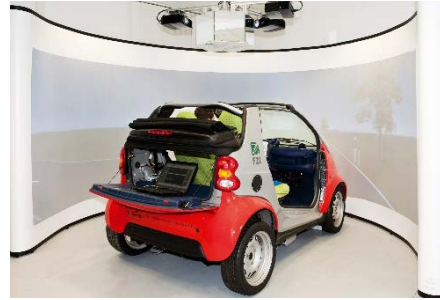
(b) Statischer Fahrsimulator basierend auf einer realen Fahrzeugkarosserie.
