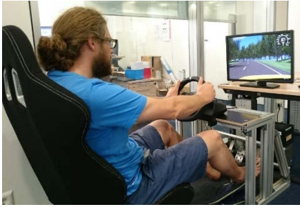
(a) Statischer Fahrsimulator mit grundlegenden Cockpit-Komponenten.
