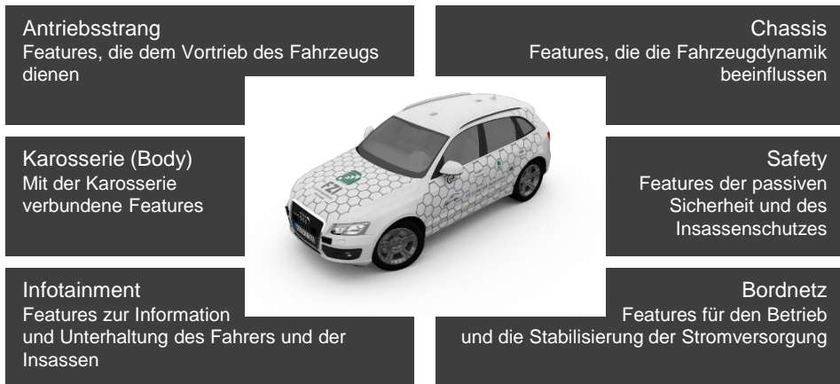
Abbildung 2.2: Aufteilung des Gesamtfahrzeugs in fachspezifische Fahrzeugdomänen
