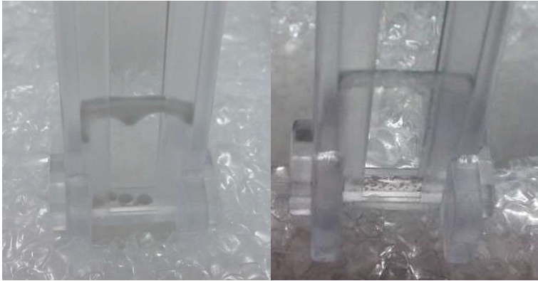
Anhang 3: Küvetten mit Schichtungen aus einer Dispersion mit SF600 über Wasser nach der Zentrifugation. Links ist eine Konzentration von 0,8% mit deutlich ausgeprägter Zwischenschicht und Tropfen von ~1mm am Küvettenboden zu sehen. Die rechte Seite zeigt eine Konzentration von 0,1% mit sehr kleinen Agglomeraten an der Phasengrenze.
