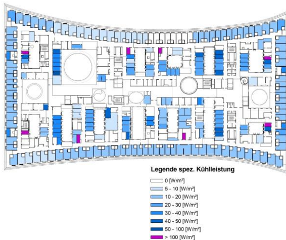
Abbildung 6: Eingefärbter Grundriss im Revit, mit spez. Kühlleistungsbedarf pro Raum aus der Simulation
