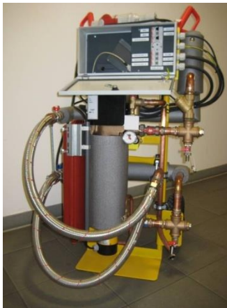
Abbildung 12: Eigenentwicklung eines fahrbaren Prüfgerätes für Thermal-Response-Tests vor Ort
