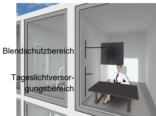
Abbildung 5: Unterteilung der Verglasungsfläche in zwei Funktionsbereiche. Konzeptskizze.
