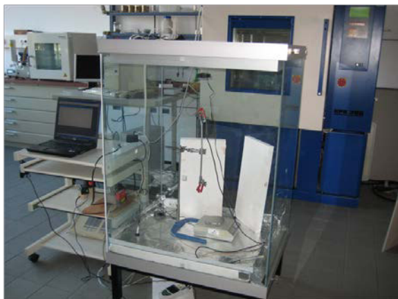
Bild 4-1: Versuchsaufbau zur Bestimmung des Luftfeuchteverlaufes
