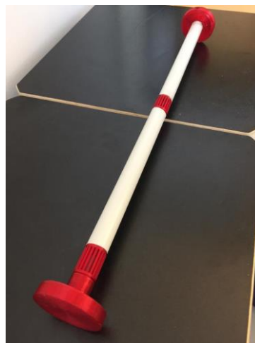
Abbildung 8: Messeinrichtung zur Erfassung der Bauteiltemperaturen und -feuchten in drei Positionen des Querschnitts der Fußbodenkonstruktion
