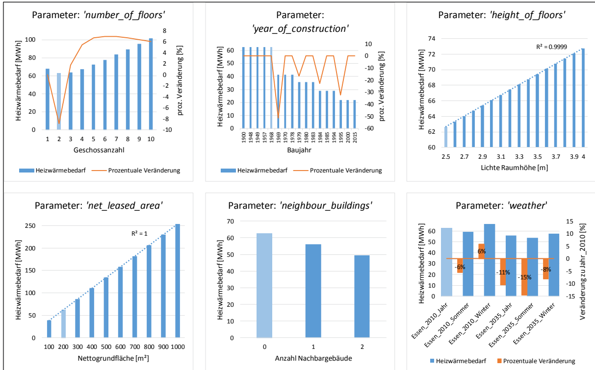
Abbildung 4: Parametereinflüsse auf den über ein Jahr integrierten Heizwärmebedarf für ein Wohngebäude
