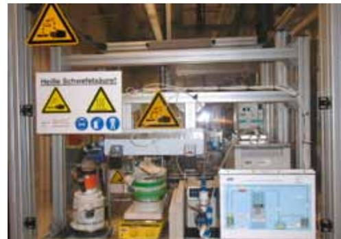
Abb. 3: Links: Schema des Durchflussteststandes für heiße Schwefelsäure; rechts: Abbildung des Teststandes; erkennbar ist die keramische Isolation der Probe in der Mitte zur Minimierung der Wärmeabstrahlung
