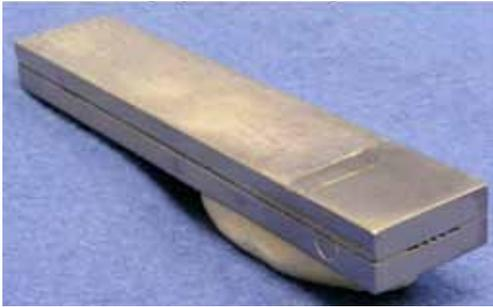
Abb. 2: Mittels CVD-Prozess tantalbeschichtete, mikrostrukturierte Probe aus austenitischem Edelstahl 1.4301
