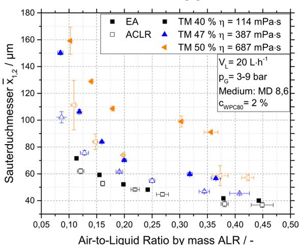
Der ACLR Zerstäuber erreicht mit steigender Viskosität und gleichem ALR kleinere Sauterdurchmesser als der EA.
