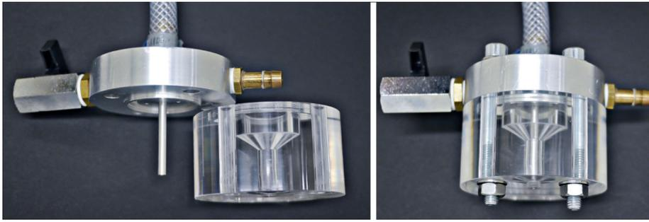
Abb. 1: Aufbau eines ACLR-Zerstäubers, demontiert in transparente Mischkammer und Gaskapillare (links) und im montierten Zustand (rechts).
