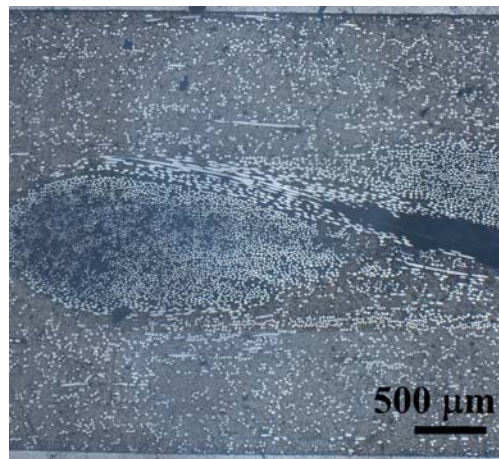
Bild 4.4: Fasernest im Schliffbild des LFT-Werkstoffes mit 40 Gew.-% Glasfasergehalt unter dem Lichtmikroskop
