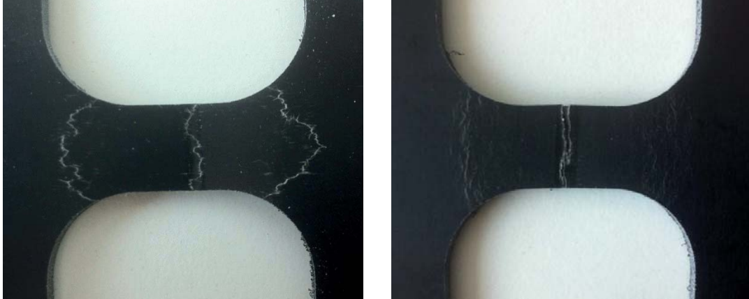
Bild 5.27: Unterschiedliche Bruchbilder der Proben im taillierten Durchstoßversuch an PP-GF30 von der Stempelindrückseite aus betrachtet, 0°-Probe (links) und 90°-Probe (rechts)
