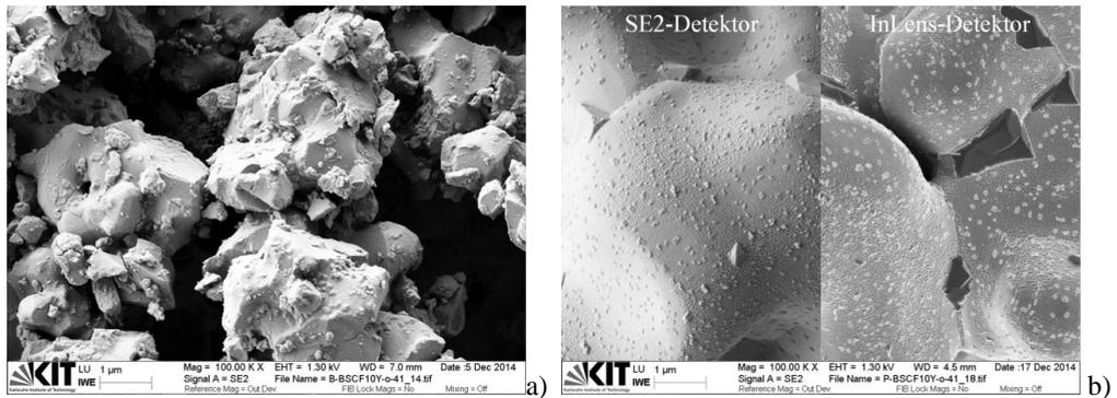
**Abb. 4.13:** REM-Analysen an P-BSCF:10Y-41 vor und nach der coulometrischen Titration (gezeigt in Abbildung 4.12). a) Pulver nach der Herstellung mit einer Partikelgröße von etwa 2 µm, b) Zersetztes Pulver nach coulometrischer Titration bei 950 °C. Es werden deutliche Ausscheidungen an Zweitphasen sichtbar.
