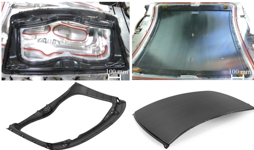
Abbildung 1: Am Fraunhofer ICT mit dem HP-RTM Verfahren hergestellte Bauteile links: Dach-Verstärkungsrahmen der Corvette C7, rechts: CFK-Dach
