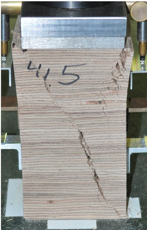
Abb. 5 Rollschubähnliches Versagen von senkrecht zur Furnierlage belastetem Buchen-FSH Typ P
