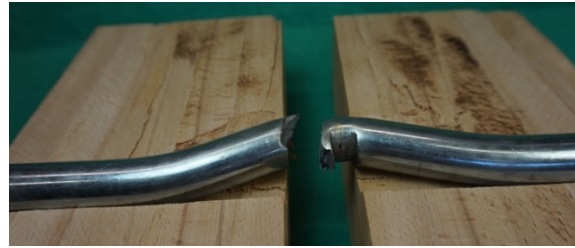
Abb. 2 Kombiniertes Biege- und Scherversagen eines Stabdübels in einer Verbindung mit innen liegendem Stahlblech und Seitenhölzern aus Buchenbrettschichtholz
