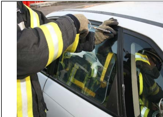
Abbildung 6: Ansetzen und Spannen eines Federkörners [Kullik, D. /2017-3/]
