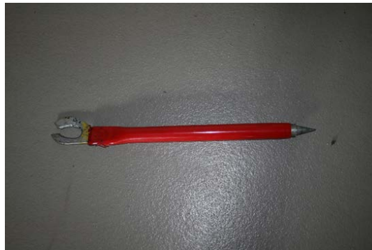
Abbildung 10: Beispiel für einen Blechaufreißer [Kullik, D. /2017-3/]
