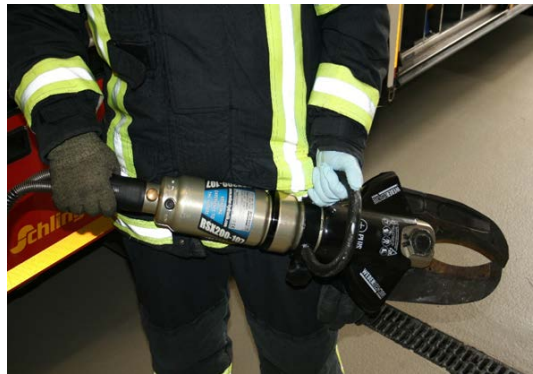
Abbildung 13: Beispiel für eine Rettungsschere [Kullik, D. /2017-3/]
