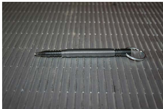
Abbildung 5: Beispiel für einen Federkörner [Kullik, D. /2017-3/]
