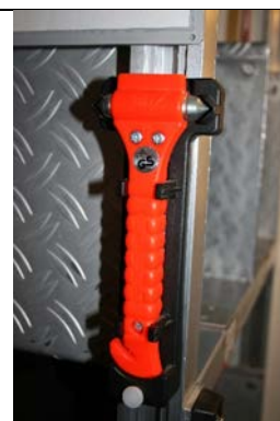
Abbildung 9: Beispiel eines Nothammers, an der Fahrzeugwand montiert [Kullik, D. /2017-3/]
