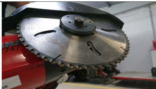
Abbildung 12: Beispiel für eine Zwillingsäge [Kullik, D. /2017-3/]
