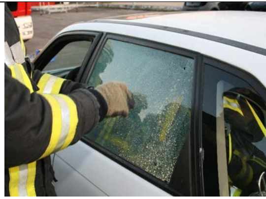
Abbildung 7: Rissbild bei der Zerstörung einer Seitenscheibe mit Federkörner [Kullik, D. /2017-3/]
