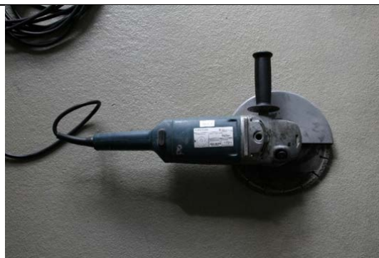
Abbildung 11: Beispiel für einen Winkel- bzw. Trennschleifer [Kullik, D. /2017-3/]
