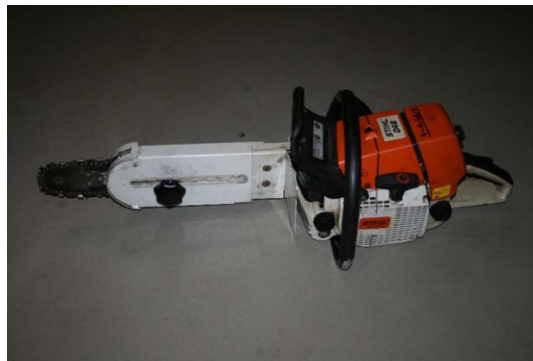
Abbildung 14: Beispiel für eine Rettungskettensäge [Kullik, D. /2017-3/]
