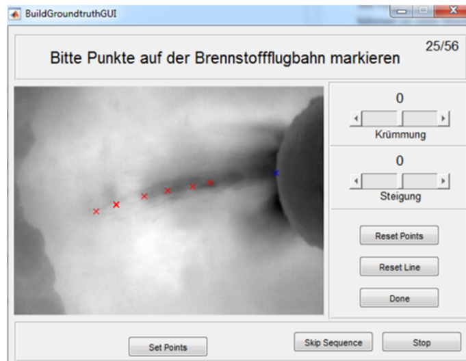
Abbildung A.3: Software-Tool: Markierung von Punkten an denen alternativer Brennstoff erkannt wird.
