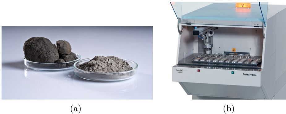
Abbildung 1.15: (a) Aufbereitete Probe für die Freikalkmessung und (b) Beispiel für ein Freikalkmessgerät CUBIX 3 der Firma PANALYTICAL [71].
