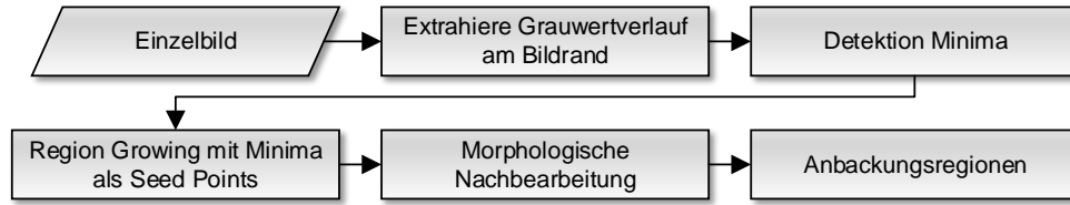
Abbildung 3.6: Ablaufdiagramm des Bildverarbeitungsalgorithmus zur Segmentierung von Anbackungen.
