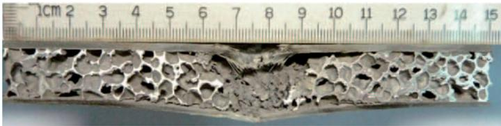
Abbildung 2.6: Vollständig perforiertes GFK-Aluminiumschaum-Sandwich nach einem LVI-Versuch [89]
