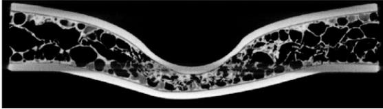
Abbildung 2.3: Nicht perforiertes Aluminiumblech-Aluminiumschaum-Sandwich nach einem LVI-Versuch [19], Sandwichhöhe 11 mm
