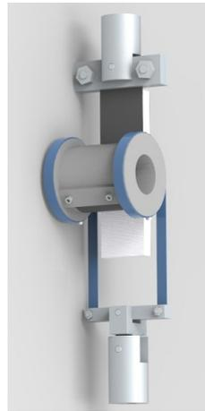
(b) Schemaskizze des Trommelschälversuchs
