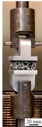
(b) Montierte Kopfzugprobe
