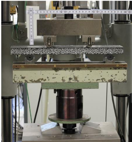
Abbildung 4.12: Aufbau der Vierpunkt-Biegeversuche
