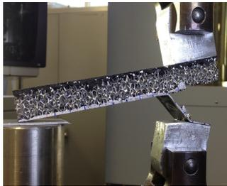
Abbildung 4.14: Eingespannte Probe im DCB-Test nach Versuchsende
