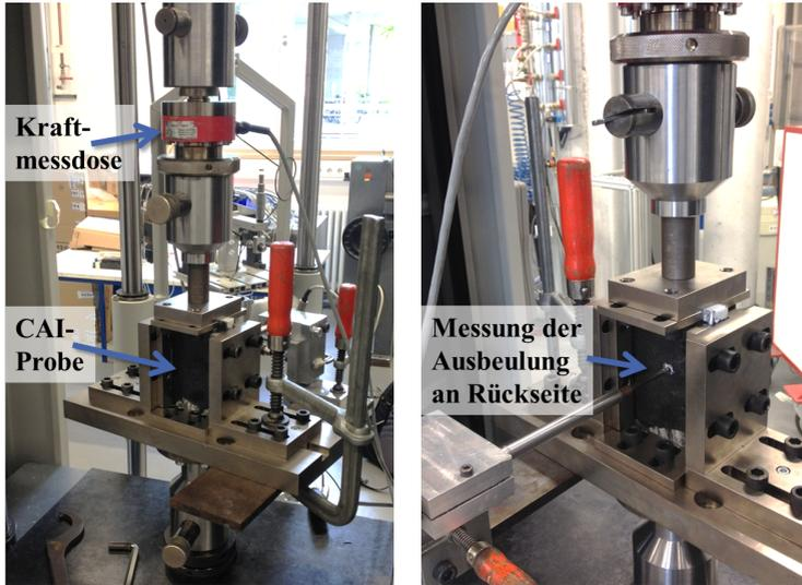
(a) Vorderansicht mit Kraftmessdose (b) Rückansicht mit taktile Verformungsmessung
