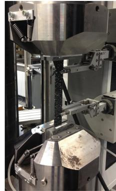
(b) Eingespannte Zugprobe mit anliegendem Extensometer
