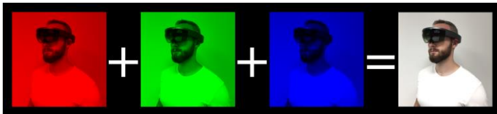
Abbildung 2.2: Zusammensetzung eines mehrfarbigen Bildes durch die Überlagerung dreier monochromatischer Bilder der Primärfarben Rot, Grün und Blau.
