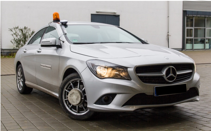
Abbildung 3.3: Versuchsfahrzeug Mercedes-Benz CLA 180 mit montierter Messtechnik.
