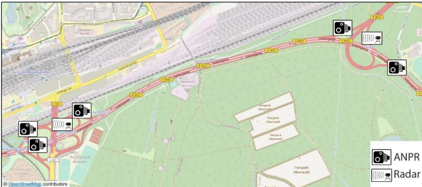
Abbildung 3-3: Prinzip der Messung am Messtag 1 (OSM)
