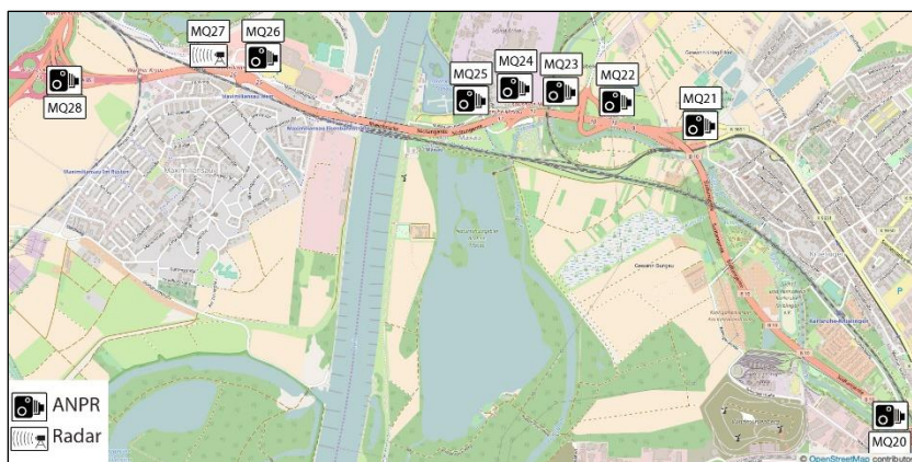
Abbildung und Tabelle A-3: Prinzip des Messaufbaus und hochgerechnete Verkehrsstärke [Kfz/h] am Messtag 4
