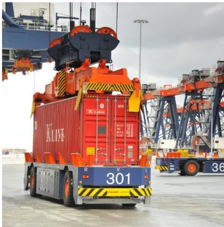
Abbildung 3.2: Automated Guided Vehicles (AVGs) in einem Container-Terminal.
