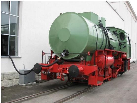
Abbildung 4.1: Die Niederdruck-Speicherlok von DLM Dampflokomotiv- und Maschinenfabrik AG beim betanken mit Dampf an der Brauerei Falken in Schaffhausen. Der Vorgang dauert rund 20 min und die Lokomotive kann damit während rund acht Stunden Züge mit einem Gewicht von bis zu 3.000 t ziehen. Stand der Technik ist jener der 1920er-Jahre. Ziel ist es, die Technologie auf heutiges Niveau anzuheben.
