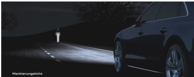
Abbildung 2.14.: Lichtverteilung eines Markierungslichts [4]
