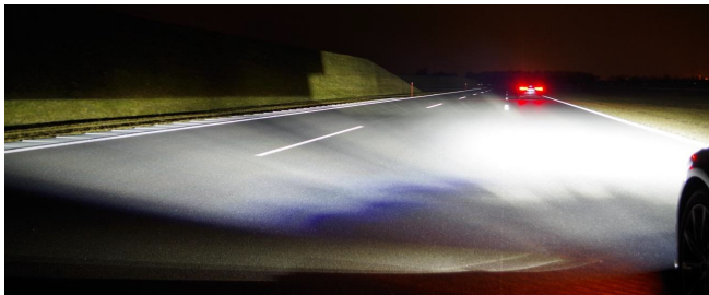
(b) Lichtverteilung der empfehlenden Lichtfunktion
