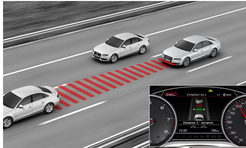
Abbildung 2.11.: Funktionsweise eines Abstandsregelautomaten [4]
