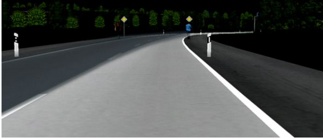
Abbildung 3.6.: Simulation einer Fahrspurausleuchtung als Basis für situationsadaptive Lichtfunktionen
