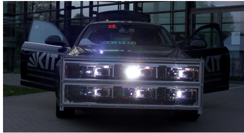
Abbildung 2.2.: Versuchsfahrzeug des Karlsruher Instituts für Technologie mit Forschungsplattform Propix [96]
