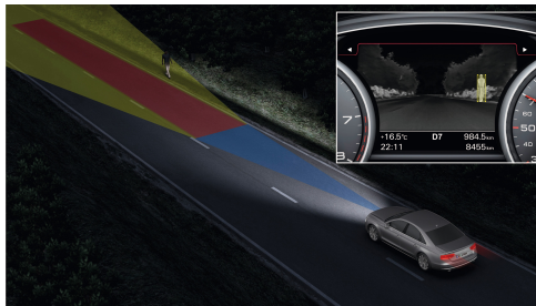
Abbildung 2.10.: Sichtbereich eines Nachtsichtassistenten mit Einteilung in Gefahrenbereiche und Darstellung im Kombiinstrument [4]
