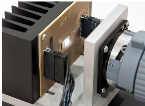
Abbildung 2.3.: Versuchsaufbau aus dem Forschungsprojekt mit Lichtquelle und Leistungselektronik \mu -AFS [105]
