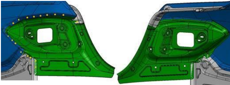
Abbildung 5.31: Detailansichten Fügebereich Beplankung Seitenwand und Heckleuchtentopf
