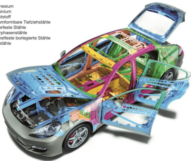
Abbildung 2.8: Karosseriematerialien eines hochpreisigen PKW [Böl-10]
