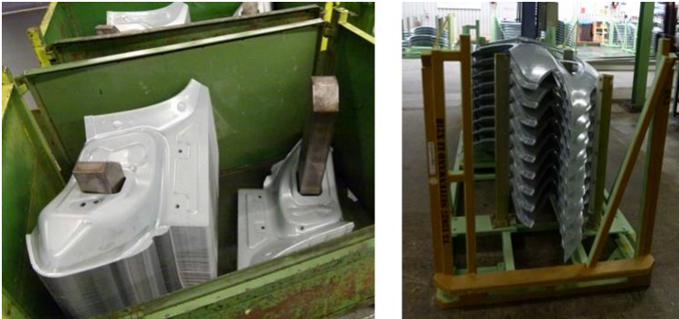
Abbildung 5.2: LT mit kontrollierter Stapelung und vollumfänglicher SLT [vgl. Wis-13, S. 12]
