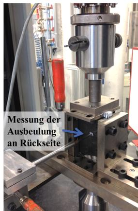
(b) Rückansicht mit taktile Verformungsmessung
