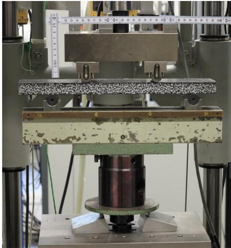
Abbildung 4.12: Aufbau der Vierpunkt-Biegeversuche
