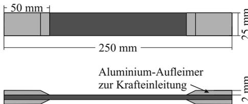
Abbildung 3.5: Probengeometrie für Zugversuche an den Deckschichten
