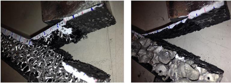
(a) Rissstart und -verlauf partiell im Kern (b) Rissverlauf unter Deckschichtfasern
