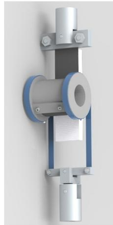
(a) Eingespannte Probe im Versuch (b) Schemaskizze des Trommelschälversuchs
