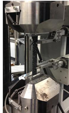
(b) Eingespannte Zugprobe mit anliegendem Extensometer
