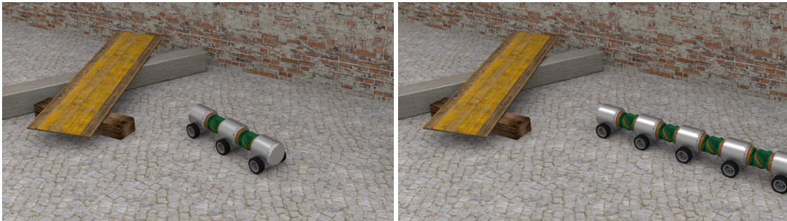
Abb. 6.1: Einfluss der Roboterkonfiguration auf die Navigations- und Bewegungsplanung.
