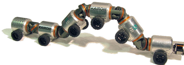
Abb. 3.5: Konfiguration eines kombinierten Roboters mit insgesamt elf Modulen.
