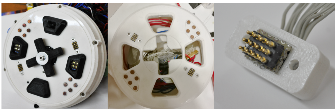
Abb. 7.3: Zusammengebauter Prototyp der KAIRO 3 Schnittstelle. Die Hauptbestandteile der aktiven (links) und passiven Schnittstelle (mittig) wurden 3-D gedruckt. Die Federkontakte zur Datenübertragung (rechts) sind mit einer 3-D gedruckten Montagehilfe in die Schnittstelle integriert [8].
