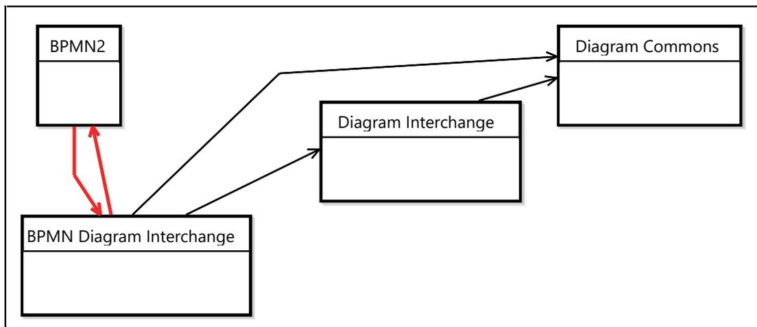
Figure 2.10: BPMN2 Module Structure
