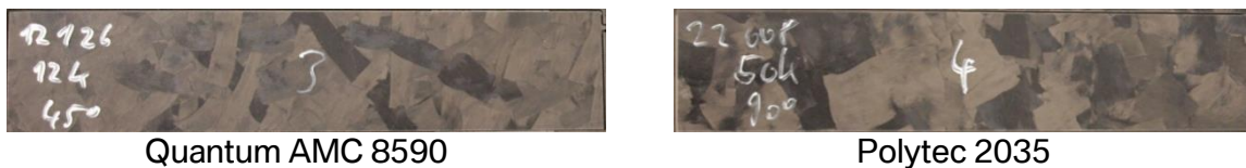
Abb. 6.2: Vergleich zweier Zugstäbe nach Wasserstrahlbeschnitt (WSS) der Testplatte
