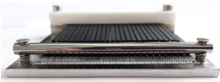
Abb. 4-13: Fertig montierte und vorgespannte Piezozoomlinse mit Linienfokus bestehend aus Linseneinheit mit einem Federstahlsubstrat und der Aktoreinheit mit Glaskeramik Andruckplatte.
