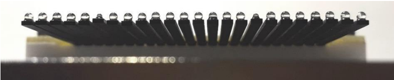
Abb. 4-11: 24 Piezoaktoren einer Aktoreinheit kopfüber gelagert. Es werden 24 Glaskugeln, wenn nötig verschiedener Durchmesser, zum Ausgleich der Lücke zwischen Aktor und Zoomlinsenssubstrat verklebt. Die höchsten Punkte der Glaskugeln sollen in einer Ebene liegen.
