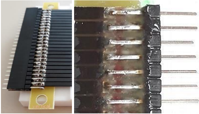
Abb. 4-10: Lötverbindung der 25 Pins einer Stiftleiste an obere Pads der 24 Piezoaktoren und vorderster Pin an GND-Pad der Leiterplatte (links). Isolierende und biegesteife Verbindung der gesamten Aktoreinheit mit Zweikomponenten-Epoxidharzkleber, welcher alle Lücken zwischen Piezoaktoren und Pins ausfüllen muss (rechts).
