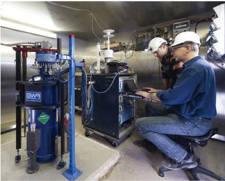
**Abb. 130:** Das SG-056 mit der Steuerungs- und Registrierungselektronik. Alle Sensoren im Stollen sind über Lichtleiterkabel mit dem Laborhaus verbunden. Nur spezielle Arbeiten werden direkt an den Sensoren durchgeführt (Thomas Forbriger, vorn, und Peter Duffner). Foto: Markus Breig, KIT.
