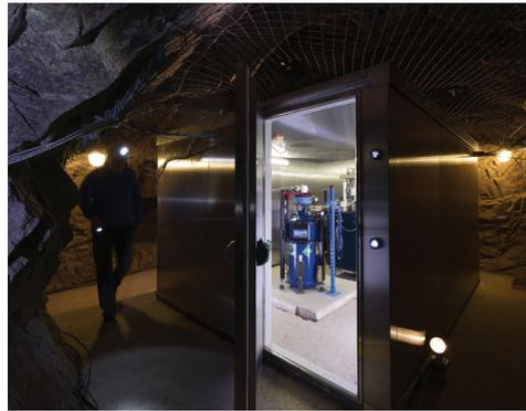
**Abb. 131:** Das Supraleitende Gravimeter SG-056 ist in einer speziellen Schutzkammer im BFO-Stollen untergebracht. Der zur Heliumverflüssigung notwendige Kompressor befindet sich in einer benachbarten Felskammer. Foto: Markus Breig, KIT.
