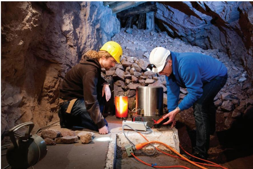
**Abb. 135:** Johannes Käufl (links), Masterstudent am GPI, und Thomas Forbriger bei der Installation eines Breitbandseismometers auf dem Testsockel im BFO-Stollen. Foto: Irina Westermann, KIT.
