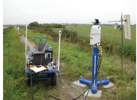
Abb. 20: GIK-Messequipment zur Bestimmung des Normalkilometers an der Universität der Bundeswehr.
