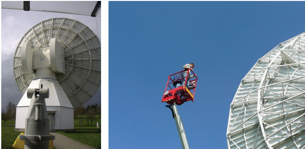
Abb. 21: Referenzpunktbestimmung am RTW, rechts beim Anbringen der Zielmarken.
