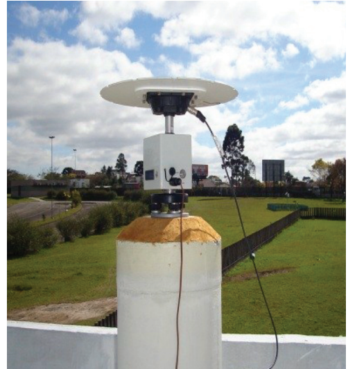
Abb. 97: Kalibriervorrichtung DRB installiert in Curitiba/Brasilien. Die baugleiche Vorrichtung wird auch am GIK eingesetzt.
