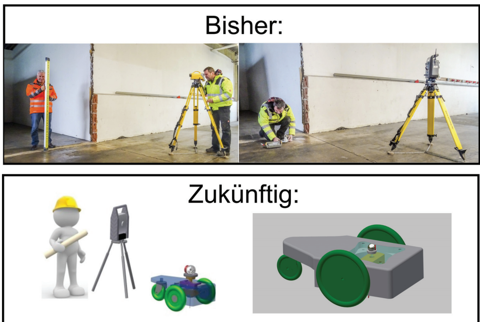
Abb. 102: Oben: bisherige personalintensive Situation: Höhenbestimmung und Markierung (Quelle: Vermessungsbüro Lingel). Unten: Einsatzszenario und Konstruktionszeichnung des derzeit am GIK in Entwicklung befindlichen nahezu personal-unabhängig arbeitenden Höhenmess- bzw. Markierungsroboters, der bis zu 70% des Personalbedarfs spart.
