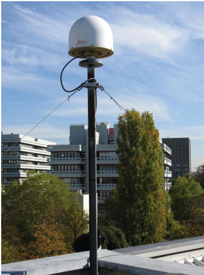
Abb. 93: Antenne der Referenzstation KARL. Foto: Kurt Seitz, GIK.
