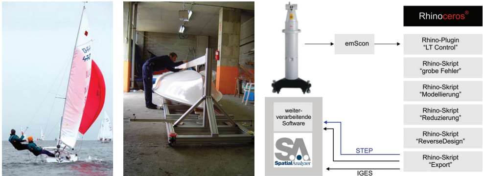
Abb. 105: Regattajolle im Einsatz (links) und bei der klassischen händischen Vermessung (Mitte); Aufbau von FLIC (rechts).
