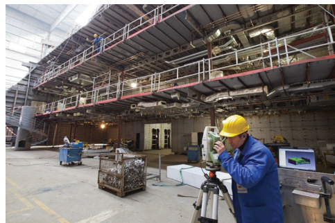
Abb. 103: Links: nahezu fertig gestelltes Kreuzfahrtschiff im Baudock der Meyerwerft. Rechts: Absteckung der Brennlinie an einem Block vor dem Fügeprozess (Quelle: Meyer Werft).
