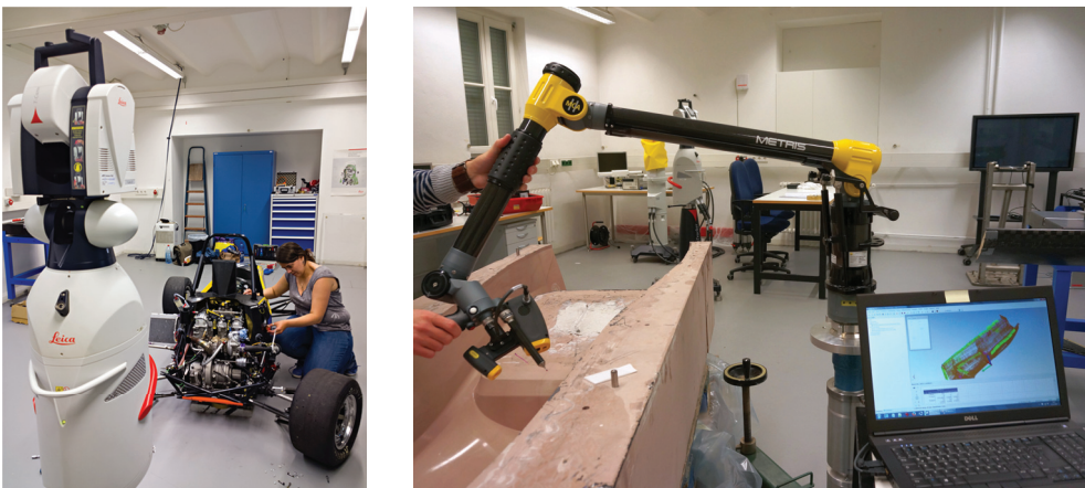
Abb. 109: Links: Einmessung der Achsschenkel beim Rennwagen mittels Lasertracker. Rechts: Kontrollmessung der Monoque-Halbschalen mittels Messarm und Linienscanner.
