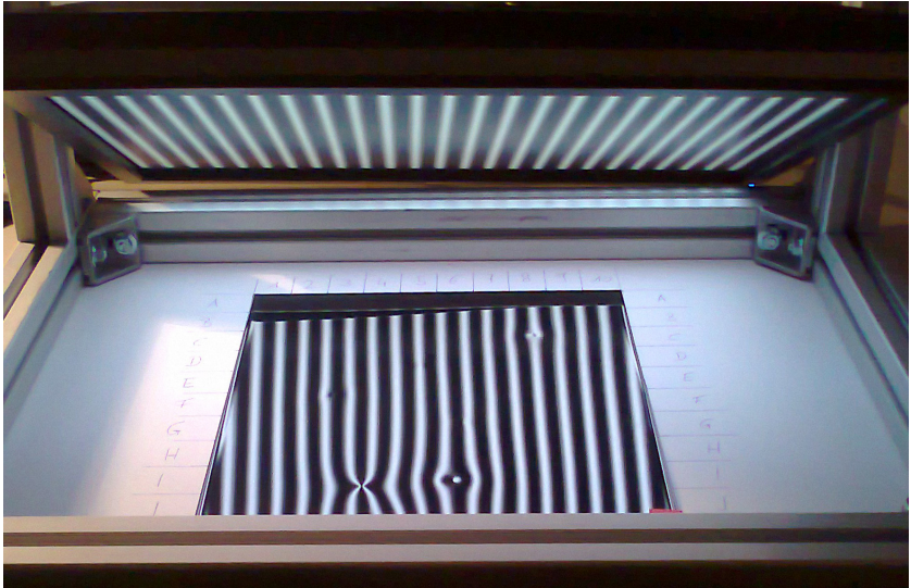
Abbildung 4.27: Studienaufbau zur Inspektion der spiegelnden Oberflächen. Auf dem Monitor wird ein Streifenmuster angezeigt, das sich in der lackierten Oberfläche der Testbleche spiegelt. Die Testbleche liegen auf einem Raster, das der Lokalisierung der gefundenen Formabweichungen dient.
