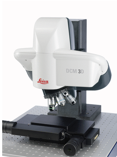
Abbildung 4.8: Für die Topographiemessungen der Oberflächen wird das Messgerät DCM3D der Firma Leica verwendet, das sowohl einen interferometrischen als auch einen konfokalen Sensorkopf besitzt.
