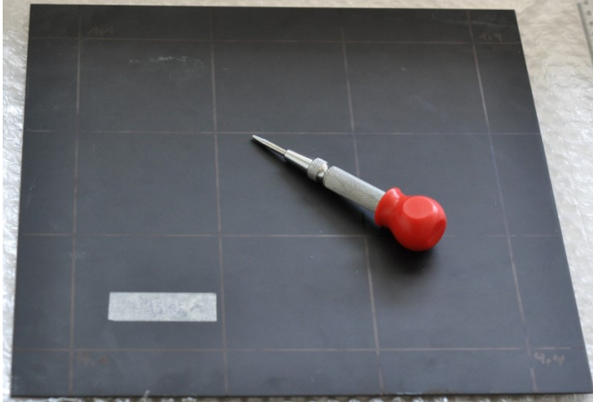
Abbildung 4.4: Rückseite eines Testblechs auf einer Luftpolsterfolie mit aufgezzeichnetem Raster und verstellbarer Federkörner, der zum Einbringen definierter Formabweichungen verwendet wurde.
