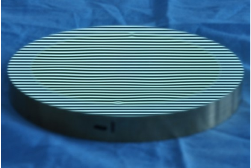
Abbildung 4.6: Diamantgedrehter Oberflächenspiegel (R2) mit 144 mm Durchmesser. Die Oberfläche ist eben und weist sechs unterschiedlich ausgeprägte konvexe Formabweichungen, sowie jeweils eine konvexe und eine konkave Verformung für die Markierung des Nord- und Südpols auf.
