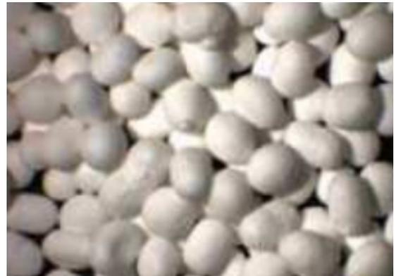
(b)  $\text{Li}_4\text{SiO}_4$ -Kugeln
