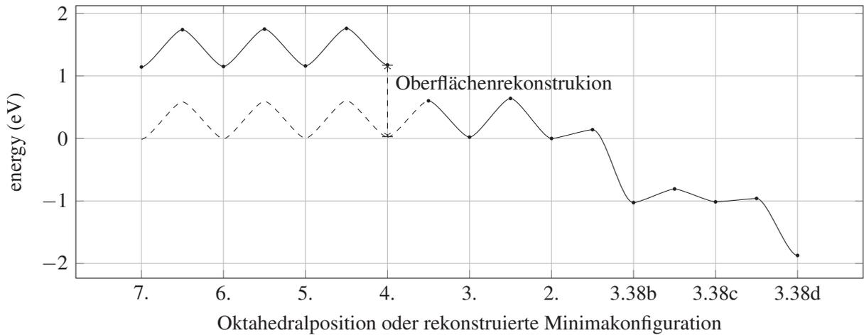
(a) Energieprofil entlang des Diffusionspfads mit besetzten Oktaedralpositionen unter der Oberfläche in den Minima.
