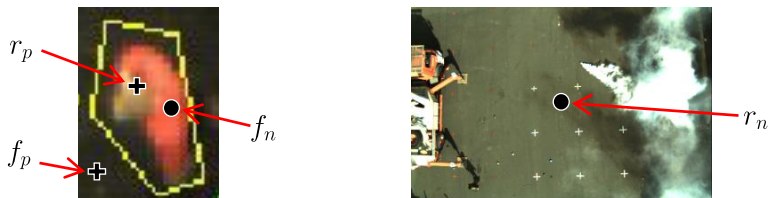
Abbildung 6.9: Übersicht über die vier Basis-Metriken. Ein Kreuz zeigt die berechnete Position und der Kreis gibt an, dass keine Position berechnet bzw. Positionsaktualisierung durchgeführt wurde.
