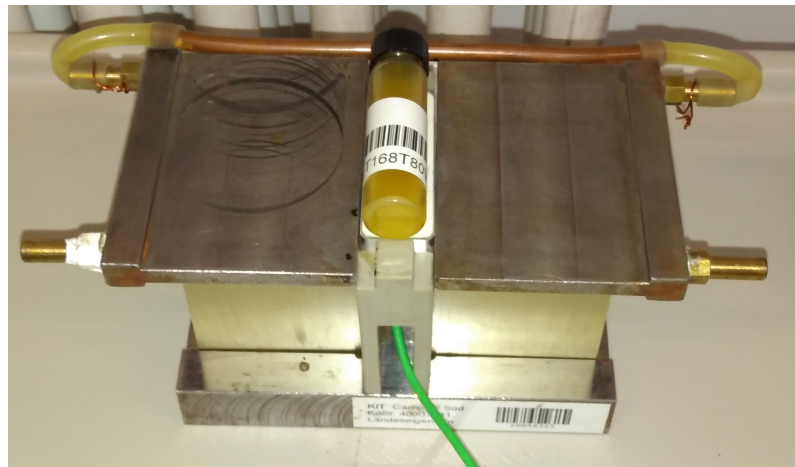
Abbildung 4.6: Foto des verwendeten Single-Sided-NMR Gerätes mit Ölprobe.
