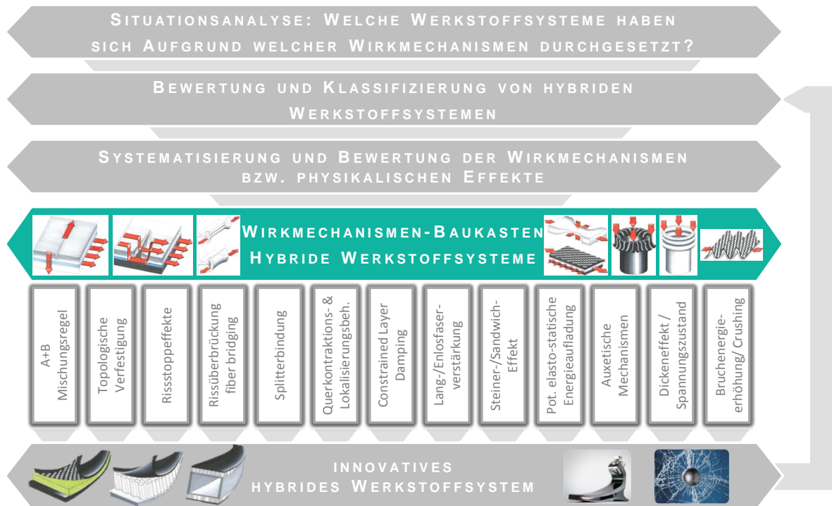
Abbildung 1.1: Allgemeine Vorgehensweise zur zielgerichteten Entwicklung mechanismenbasierter innovativer hybrider Werkstoffsysteme.
