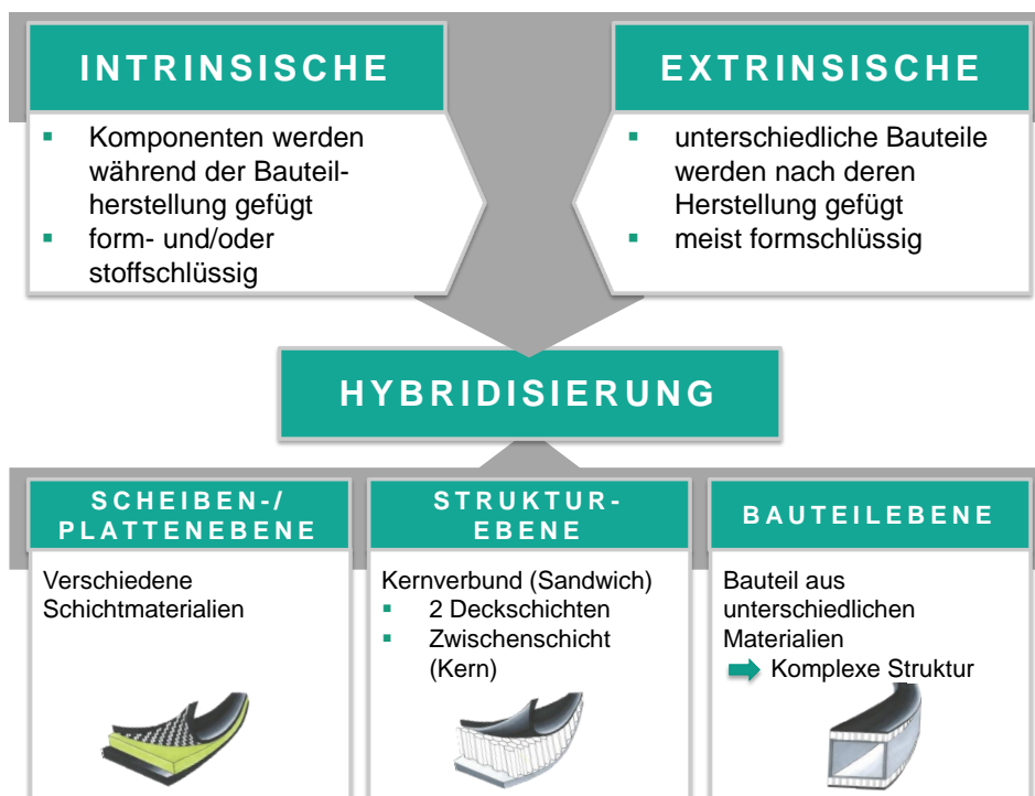
Abbildung 2.2: Gegenüberstellung der Definitionen und Unterscheidungsmerkmale für intrinsische und extrinsische Hybridisierung.
